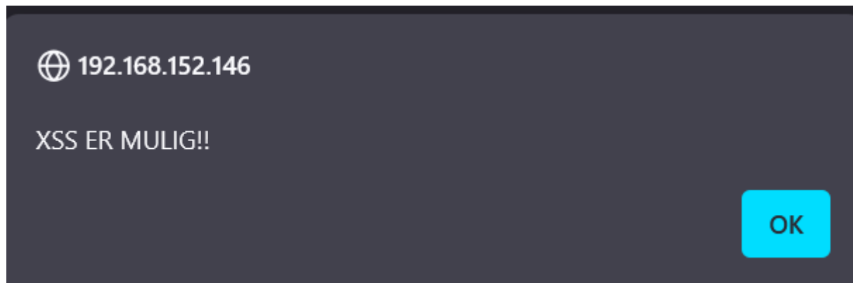
Figur 29: Bekrefter at XSS er mulig ved å injisere kode i nettleseren til store_viewdetails.php?id= .
